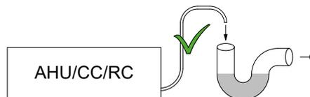
Vi anbefaler at der monteres en vandlås på spillevandssystemet for at undgå dårlig lugt fra spildevandssystemet.
