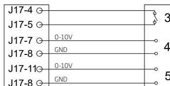
A-BMS lægger 13,5 VDC udgangssignalet via en kontakt (NO) (3) fra klemme J17-4 til klemme J17-5 (AI#1). Derved starter og stopper ventilationsanlægget iht. A-BMS programmering.
